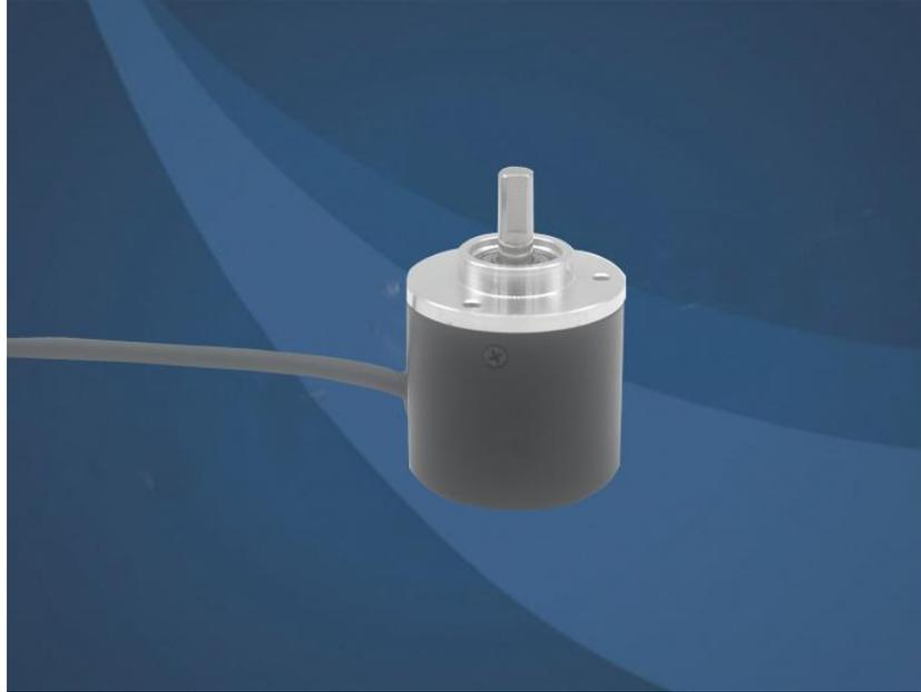
绝对值编码器为每一个轴的位置提供一个独一无二的编码数字值。特别是定位控制应用中,绝对值编码器减轻了电子接收设备的计算任务,从而省去了复杂的和昂贵的输入装置。而且,当机器合上电源或电源故障后再接通电源,不需要回到位置参考点,就可利用当前的位置值。多圈绝对值编码器不仅能在圈内测量角位移,而且能利用多步齿轮测量圈数。多圈的圈数为 12 位,4096 圈可以被识别。总的分辨率可达到 25 位。
