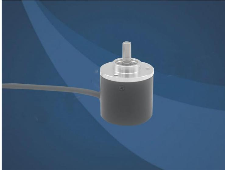
该款为增量型旋转编码器，工作原理为轴的每圈转动，增量型编码器提供一定数量的脉冲，周期性的测量或者单位时间内的脉冲数可以用来测量移动的速度，如果在一个参考点后面脉冲数被累加，计算值就代表了转动角度或行程的参数，双通道编码器输出脉冲之间相差为90°，能使接收脉冲的电子设备接受轴的旋转感应信号，因此可用来实现双向的定位控制，另外，三通道增量型旋转编码器每一圈生产一个称之为零位信号的脉冲。
