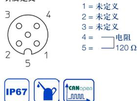
5 针 M12x1 内置 120Ω 终端电阻, A 型
